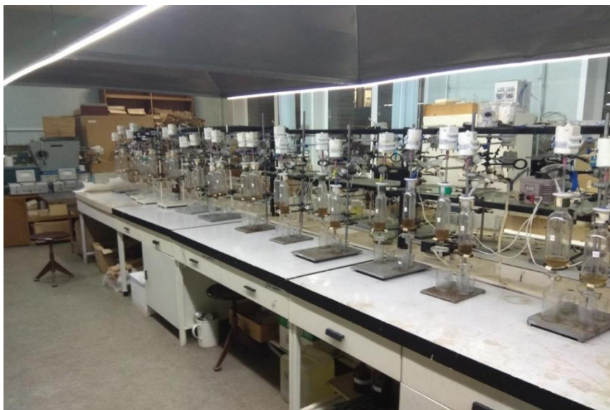
Рисунок 5.5 - Внешний вид лабораторного 60-ти ступенчатого экстракционного каскада на основе стеклянных делительных воронок
