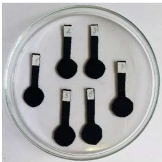
Рисунок 2.5 - Электроды на основе углеродной бумаги Toray с впрессованным УМ
