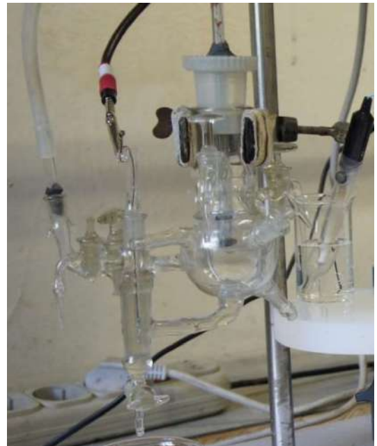
Рисунок 2.2 - Трехэлектродная электрохимическая ячейка с разделенными электродными пространствами
