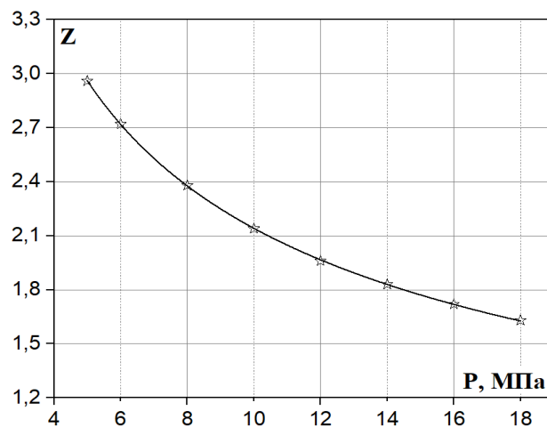
Рисунок 3.85 – Зависимость эффективности действия 3%СН+1%УНТ от давления при горении образца №2.
