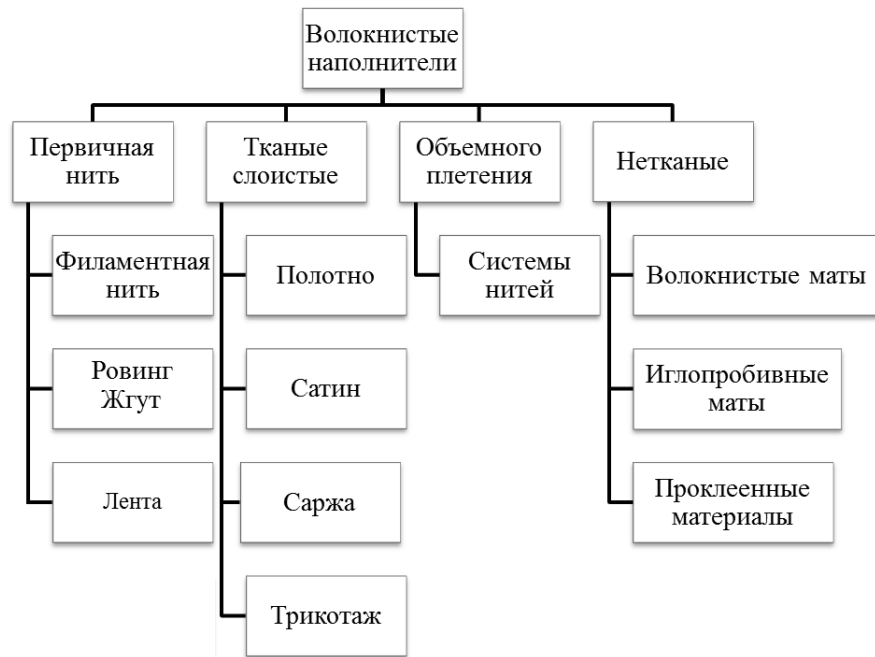
Рисунок 1.6.2 – Различные формы волокнистых армирующих наполнителей [106]
