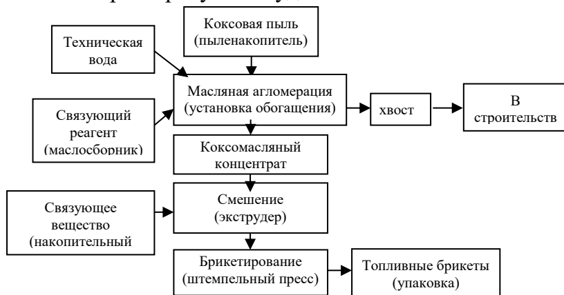
Рисунок 1 – Принципиальная аппаратурно-технологическая схема брикетирования коксовой пыли со
