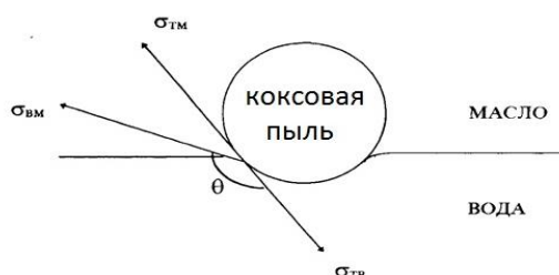
Рисунок 2.1.1 – Схема действия сил на трехфазной границе масло - угольные частицы - вода
