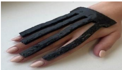
Рисунок 15 - Результат процесса 3D-печати с использованием вязких «чернил» на основе альгината натрия с внедренными наноматериалами
