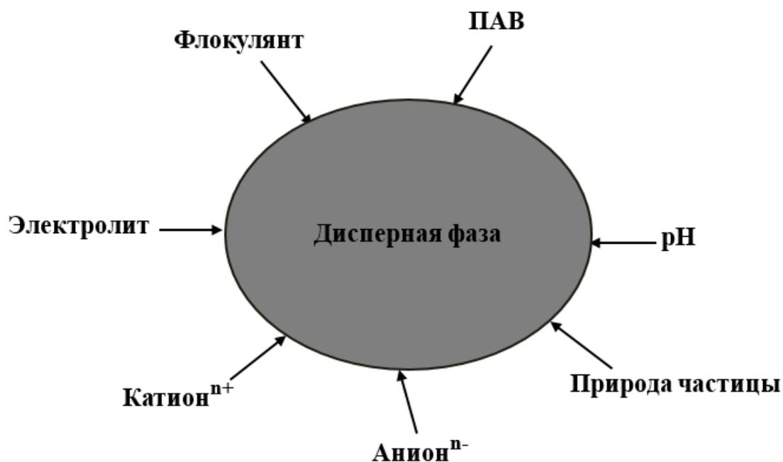
Рисунок 1.3 – Схема управления процессом формирования дисперсной частицы
