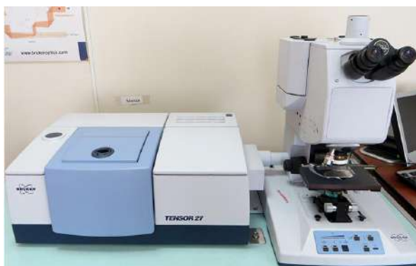
Рисунок 2.6 - ИК Фурье-спектрометр Bruker Tensor 27
