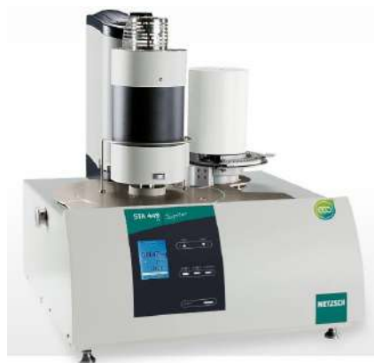
Рисунок 2.2 – Прибор Netzsch STA 449 F3 Jupiter для СТА
