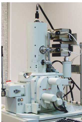
Рисунок 2.13 – Микроскоп JSM-7001F фирмы Jeol (Япония)
