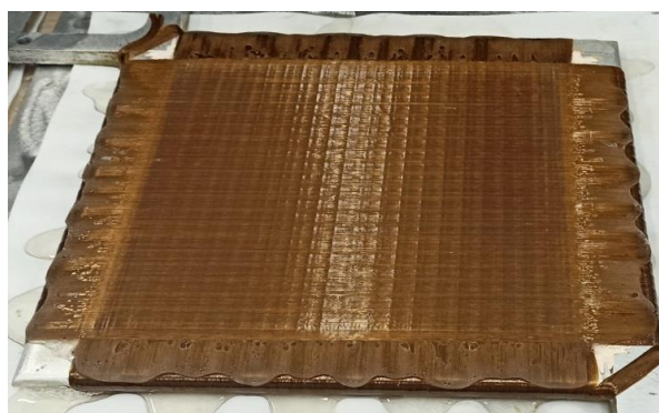
Рисунок 13 – Изготовленная методом нитяной намотки с применением ультрафиолетового облучения бронепанель: а – процесс намотки; б – отвержденный в прессе образец
