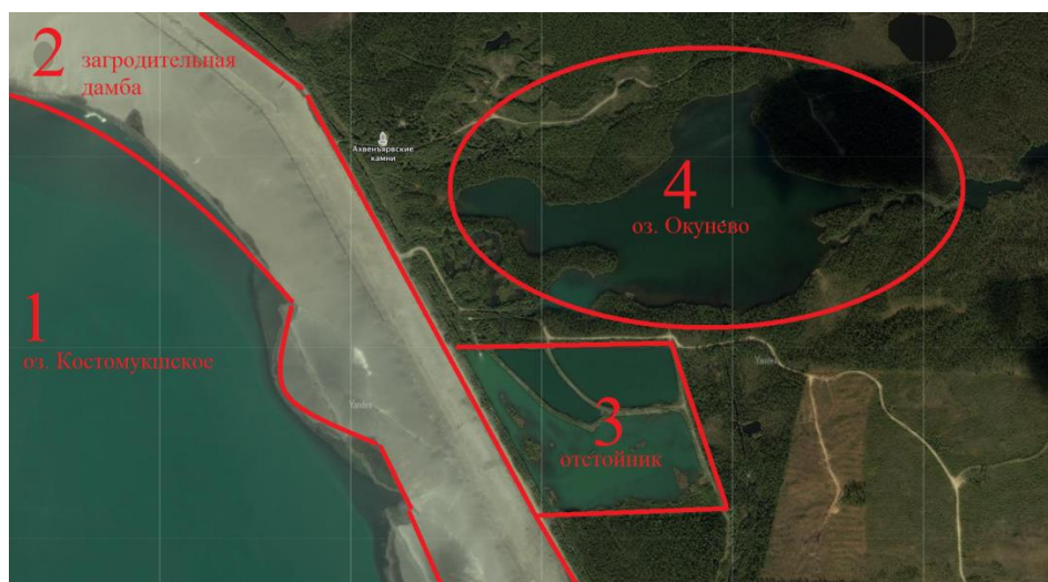
Рисунок 1.3 – Отстойник озера Костомукшское: 1) оз. Костомукшское; 2) загородительная дамба; 3) отстойник; 4) оз. Окунево.
