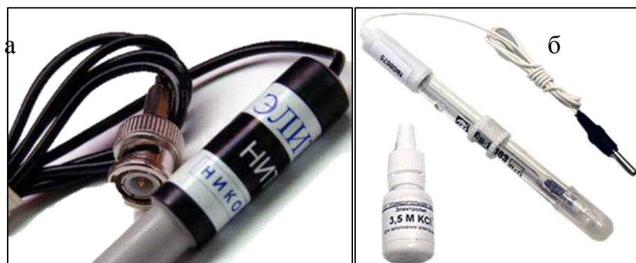
Рисунок 2.15 – Измерительные электроды: а) электрода ЭЛИТ-021; б) электрода сравнения ЭСр-10103/3.0
