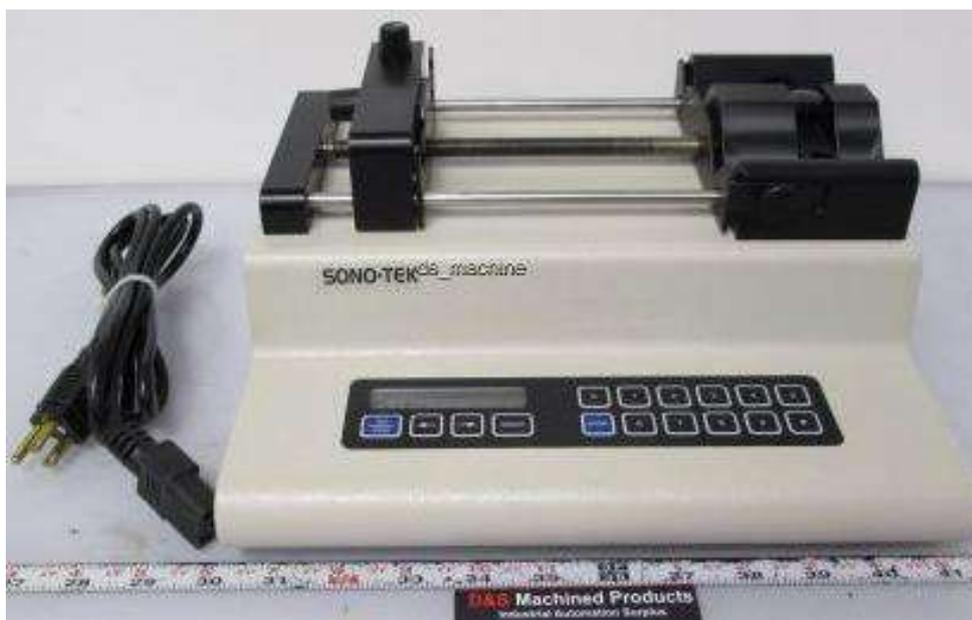
Рисунок 2.3 – Шприцевой насос Sono-Tek 12-05126 Dual Syringe Pump
