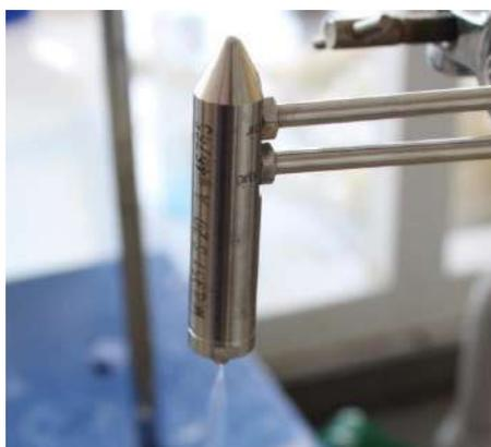
Рисунок 2.9 – Пневматическая форсунка внешнего смешения Glatt
