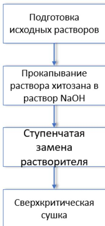
Рисунок 2.2 – Схема получения частиц хитозановых аэрогелей капельным методом
