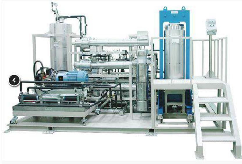
Рисунок 1.17 – Пилотная установка для сверхкритической сушки аэрогелей от компании «ГК Креатор», РФ
