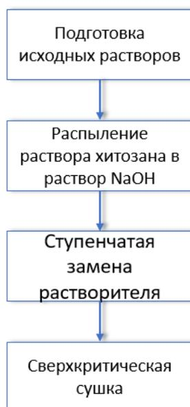
Рисунок 2.8 – Схема получения микрочастиц хитозанового аэрогеля методом распыления через форсунку
