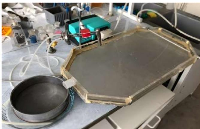
Рисунок 4.13 – Внешний вид установки для проведения процесса гелеобразования частиц хитозанового геля
