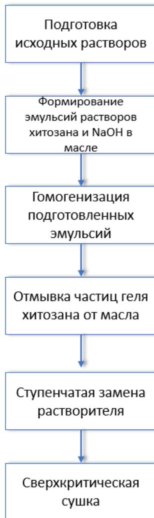
Рисунок 2.10 – Схема получения микрочастиц хитозанового аэрогеля масляно-эмульсионным методом
