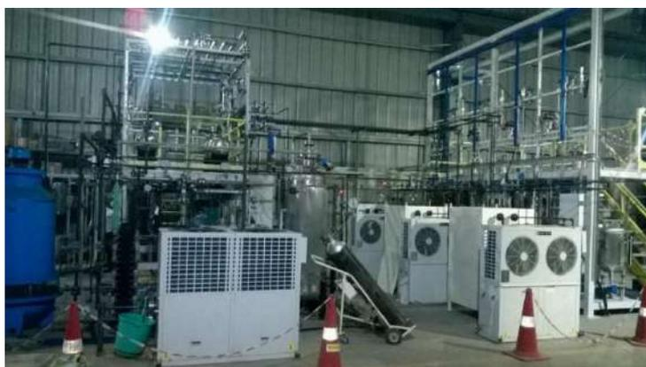
Рисунок 1.15 – Пилотная установка для сверхкритической сушки аэрогелей
