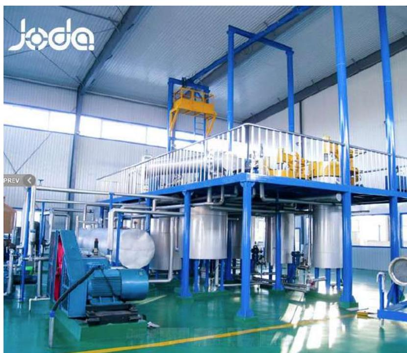
Рисунок 1.16 – Промышленная установка для сверхкритической сушки аэрогелей от компании JODA, Китай
