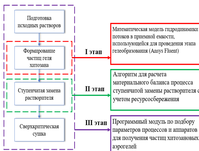
Рисунок 8 – Этапы математического моделирования процессов получения частиц хитозановых аэрогелей
