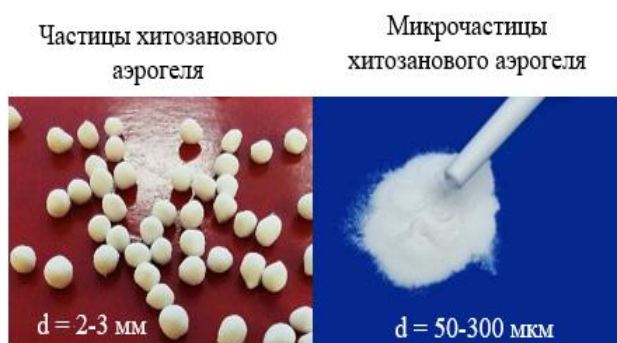
Рисунок 2 – Внешний вид частиц и микрочастиц хитозановых аэрогелей
