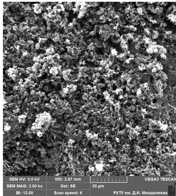
Рисунок 3.33 - Структура поверхности горения образца с 2%ДАФ-2 +3% УНТ, погашенного при P = 1 МПа
