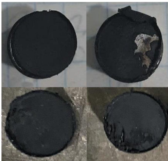
Рисунок 3.82 - Локальные очаги воспламенения, образовавшиеся при ударе образца с 1,5% Ф-4
