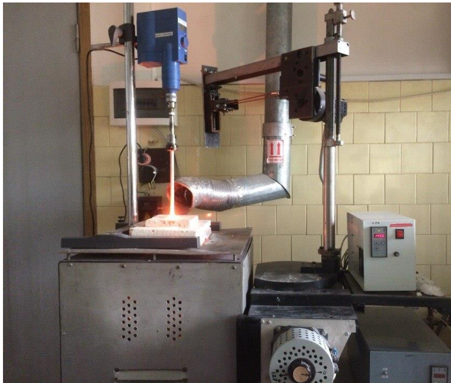
Рисунок 14 – Лабораторная печь шахтного типа с SiC нагревателями для варки стекла
