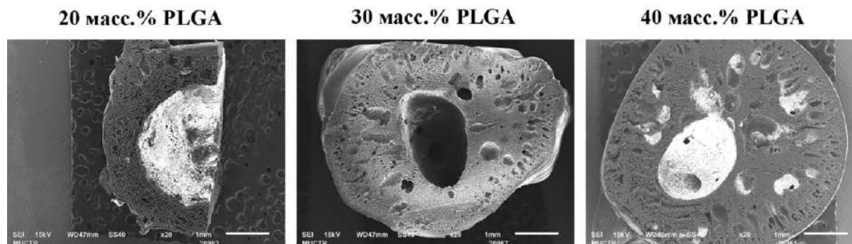
Рисунок 18 - Микрофотографии PLGA имплантатов, нагруженных рилпивиринном, полученные с помощью СЭМ (микроскоп JSM-6510LV (JEOL, Япония); напыление платина)
