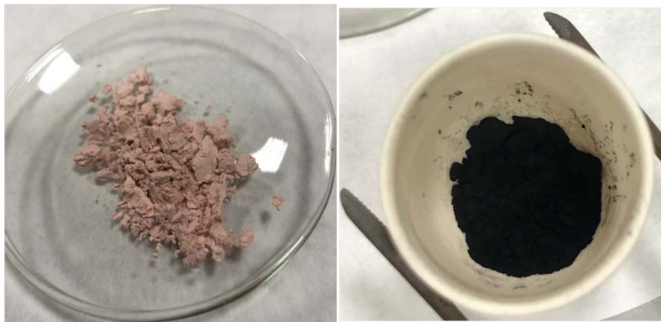
Рисунок 59 – Оксалат (а) и оксид кобальта (б), полученные при сорбционной переработке солянокислых растворов выщелачивания шлифотходов суперсплава
