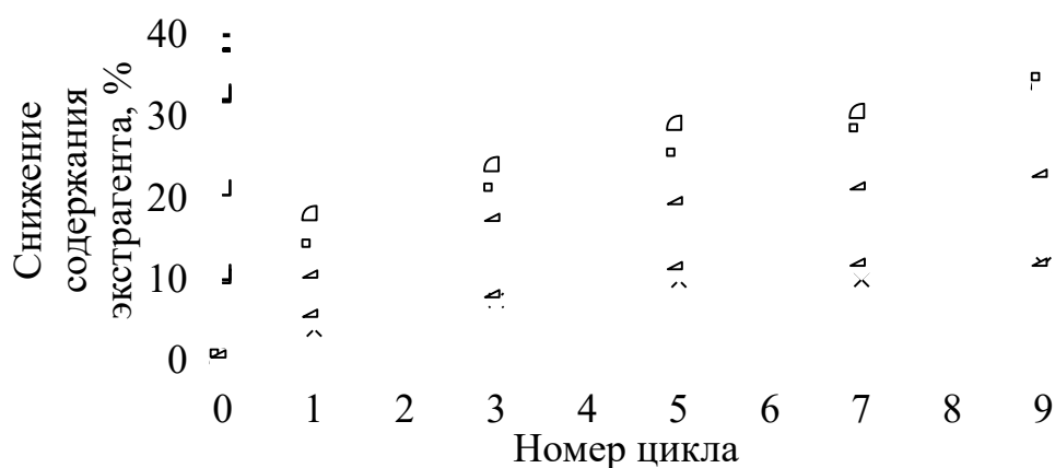
Рисунок 27 – Снижение содержания экстрагента в циклах сорбции- десорбции от его исходного содержания
