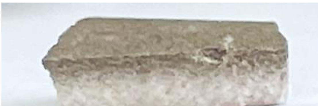
Рисунок 3.24 – Фотография образца мембраны с нанесенным слоем, полученным при использовании золя смеси оксидов марганца и кобальта (пояснения в тексте).
