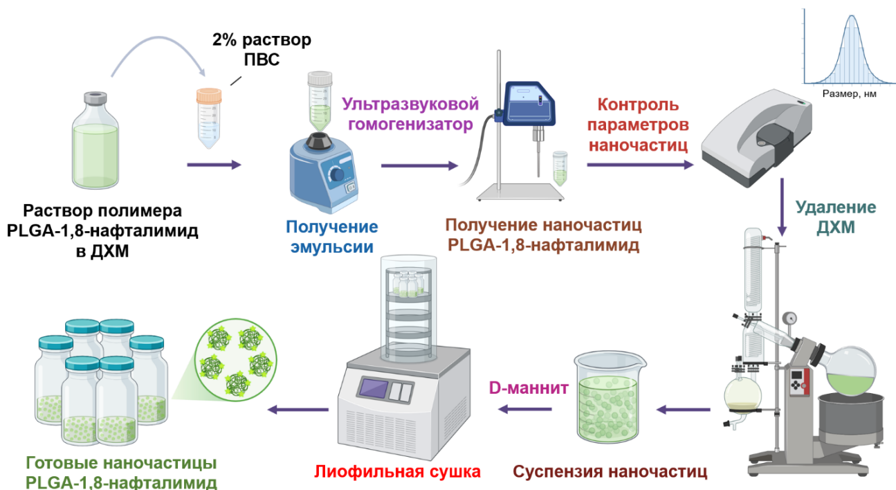
Рисунок 45 – Схема получения наночастиц ультразвуковым методом
