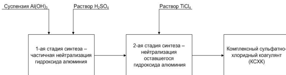
Рисунок 3 – Упрощенная блок-схема процесса получения сульфатно-хлоридного коагулянта
