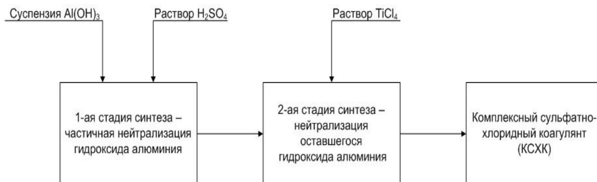
Рисунок 16 – Упрощенная блок-схема процесса получения сульфатно-хлоридного коагулянта
