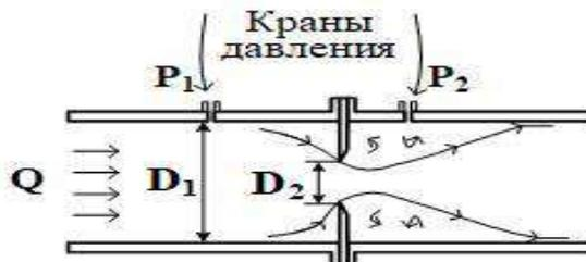
Рисунок 2.11 – Схема измерительной системы расхода по перепаду давления.
