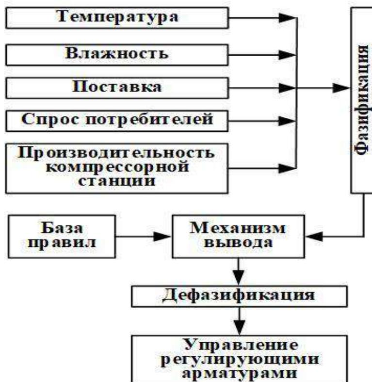
Рисунок 1.1 – Укрупненная блок-схема системы управления газопроводом
