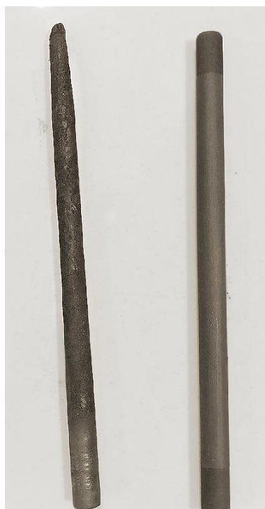
Рисунок 16. — Пример поврежденного графитового нагревателя (слева) печи высокотемпературной карбонизации в результате воздействия кислорода при температуре процесса
