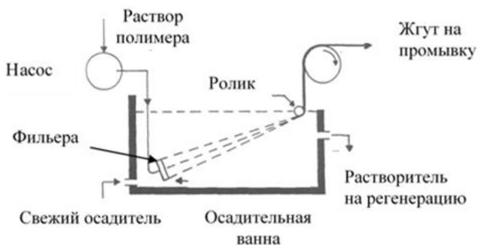
Рисунок 6 — Схема осадительной ванны для мокрого формования
