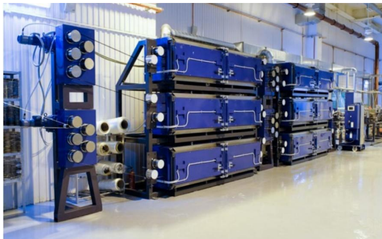
Рисунок 1 – Печи термостабилизации ПАН-волокна, входящие в состав ОЛП УВ
