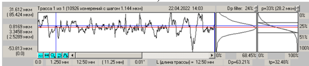
Рисунок 7.5 – Профилограммы поверхности реза углепластиков без материала жидкой фазы (а) и с диметакрилатом триэтиленгликоля (б)
