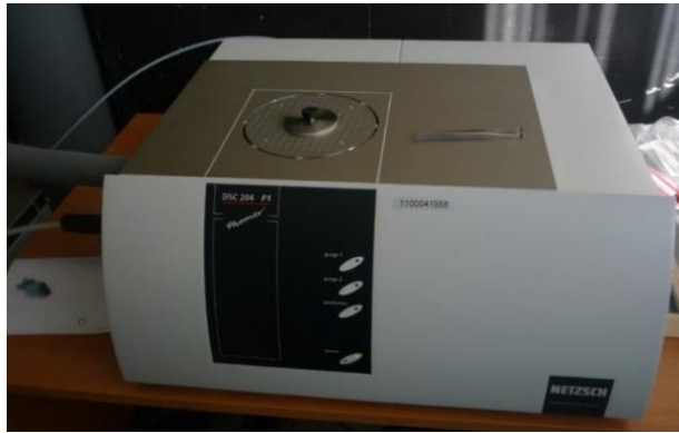
Рисунок 2.5 – Фото прибора DSC 204 F1 (Phoenix® NETZSCH-GERAETEBAU GmbH)
