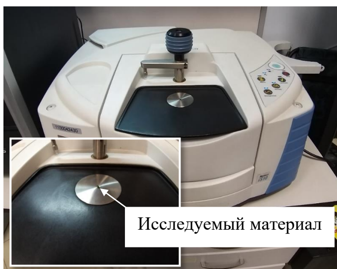
Рисунок 2.2 – ИК-Фурье спектрометр Nicolet iS10 (а), фото экрана в процессе выполнения ИК-спектроскопии (б)
