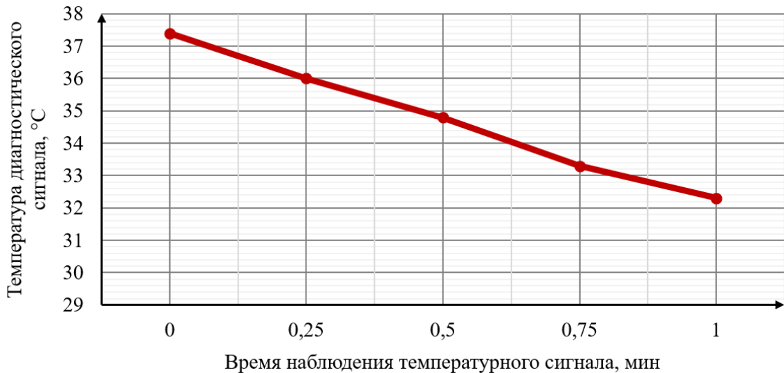
Рисунок 4.11 – Изменение максимальной температуры диагностического сигнала в зависимости от времени наблюдения для углепластика, содержащего в качестве материала жидкой фазы синтетический воск
