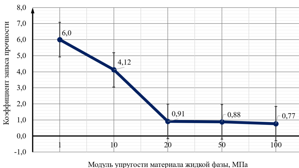
Рисунок 14 – Результаты моделирования значений коэффициентов запаса прочности в зоне материала жидкой фазы в зависимости от его упругих характеристик
