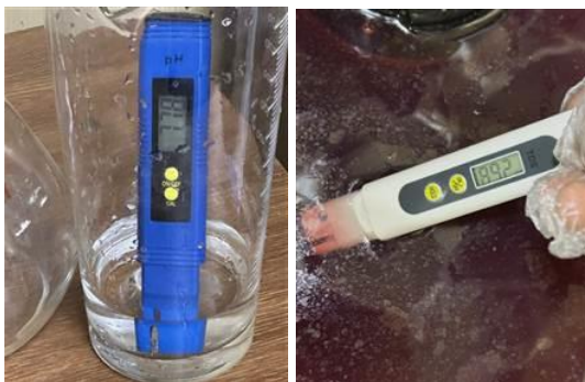
Рисунок 2.17 – Фотографии используемых приборов: слева - рН-метр PH-009(I), справа - кондуктометр карманный «HM Digital EC-3»
