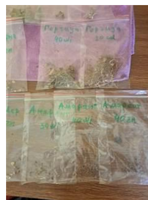
Рисунок 2.28 – Образцы биомассы тест-культур в zip-пакетах, подготовленные к высушиванию при 60 °C до постоянной массы
