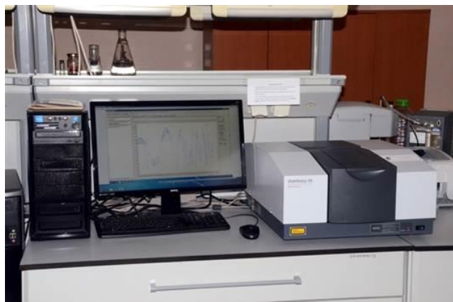
Рисунок 3.20 – Инфракрасный Фурье-спектрометр «Shimadzu IR Affinity-1S»
