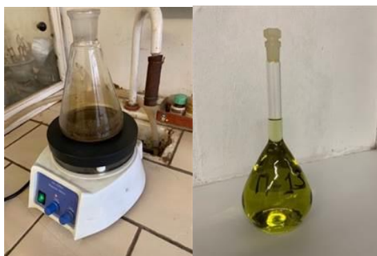
Рисунок 2.32 (а, б) – Пробподготовка растений на содержание ТМ с помощью ААС. а – кислотная вытяжка, б – готовый раствор с ТМ для передачи на анализ ААС
