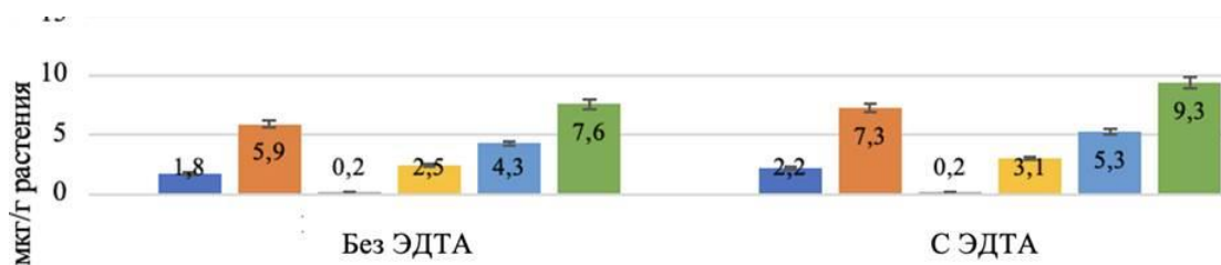
Рисунок 3.37 – КБА для ТМ при концентрации \text{Cd}^{2+} (20 мг/л), \text{Ni}^{2+} (40 мг/л), \text{Zn}^{2+} (230 мг/л)
