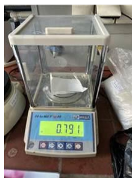
Рисунок 2.2 – Лабораторные аналитические весы МЛ 0,2-1 В1Ж Ньютон ГЛС
