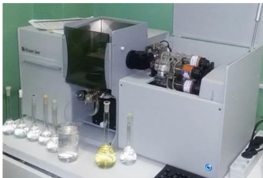
Рисунок 2.33 – ААС КВАНТ-2МТ (Россия) с пламенной атомизацией
