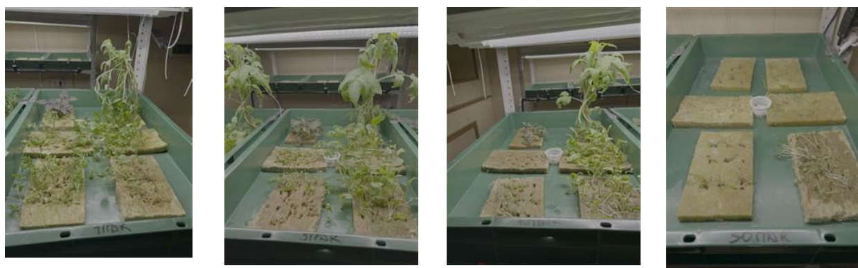
Рисунок 2.22 – Контейнеры 2 этапа III серии с концентрацией полиметаллической смеси 10, 20, 30, 40 мг/л \text{Cd}^{2+}
