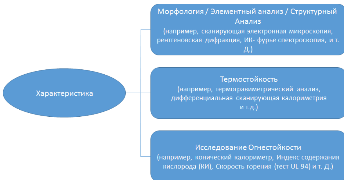
Рисунок 2.6–Схема методов исследования полимерных нанокомпозитов.
