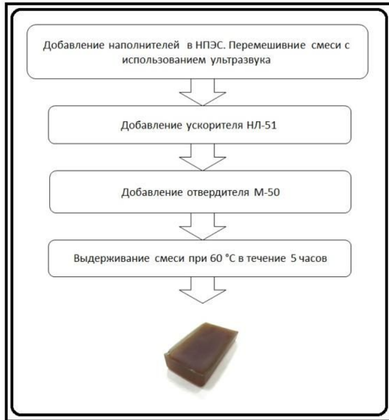
Рисунок 2.4—Стадии получения нанокompозита на основе НПЭС.
