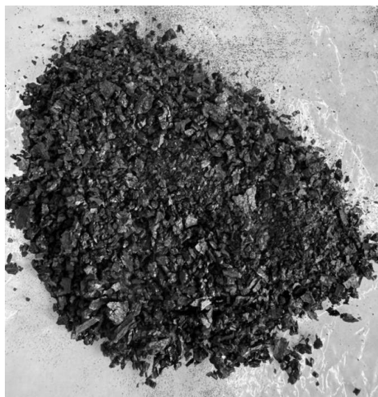
Рисунок 11 – Массив фрагментов активного угля, полученного из сырьевой композиции с массовым отношением K_2CO_3 к сырью 2:1
