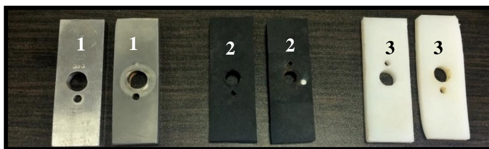
Рисунок 35 – Образцы материалов для оценки степени истирания (слева – до испытания, справа – после испытания): 1 – Ст20; 2 – TPV; 3 – HDPE
