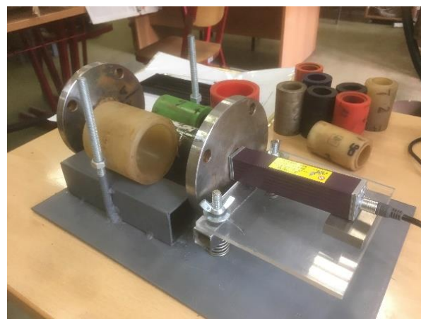
Рисунок 29 – Профилометр (слева); приспособление для измерения шероховатости (справа)
