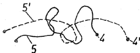
Рисунок 8 – Расстояние между узлами сшивки эластомера до (4, 5) и после пропитки набухающими агентами (4', 5') [54]
