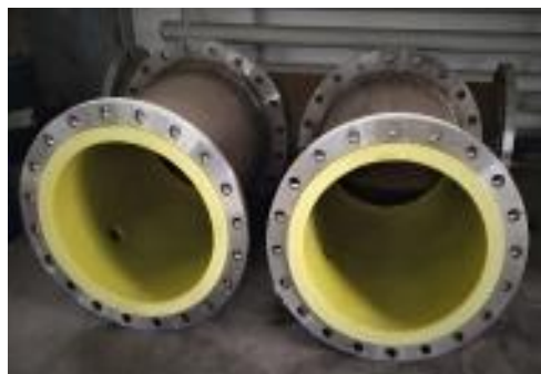
Рисунок 5 – Стальные трубы, футерованные изнутри полиуретаном [28]
