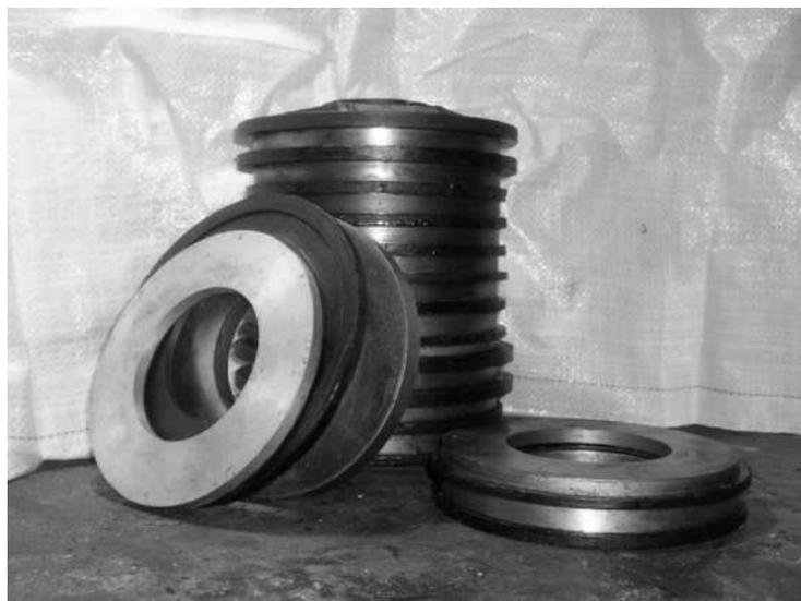
Рисунок 26 – Оправки для намотки однонаправленных композиционных материалов: 1 – основные кольца, 2 – промежуточные кольца, 3 – вал с гайкой
