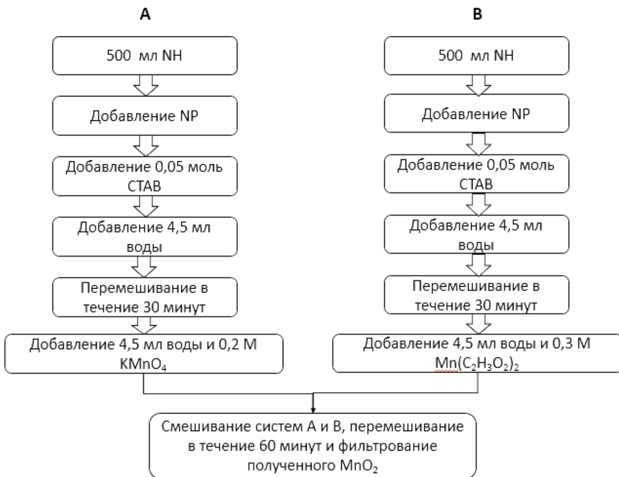
Рисунок 1.6 – Схема получения наночастиц \text{MnO}_2 микроэмульсионным методом [55]
