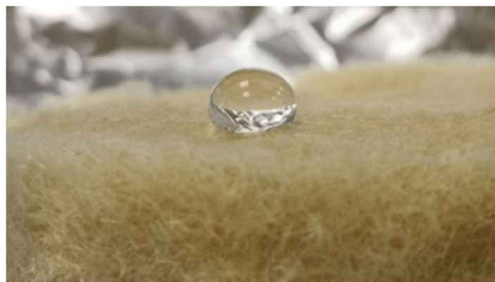
Рисунок 10 – Образец гидрофобного сорбента с каплей воды
