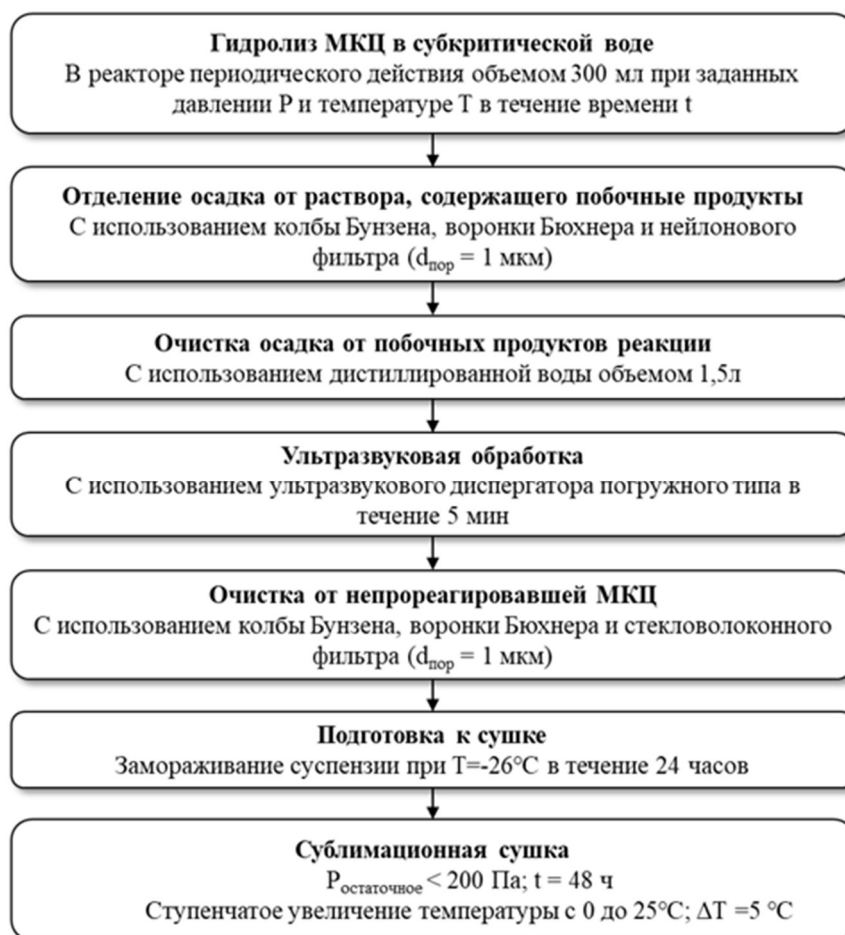
Рисунок 2 – Схема переработки целлюлозы в субкритической воде
