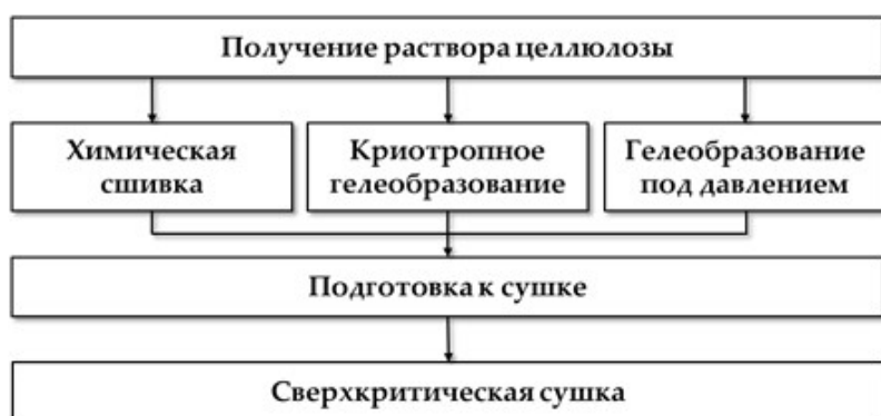
Рисунок 5 – Общая схема получения аэрогелей на основе целлюлозы
