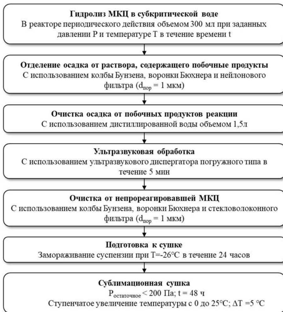
Рисунок 2.3 – Схема переработки целлюлозы в субкритической воде
