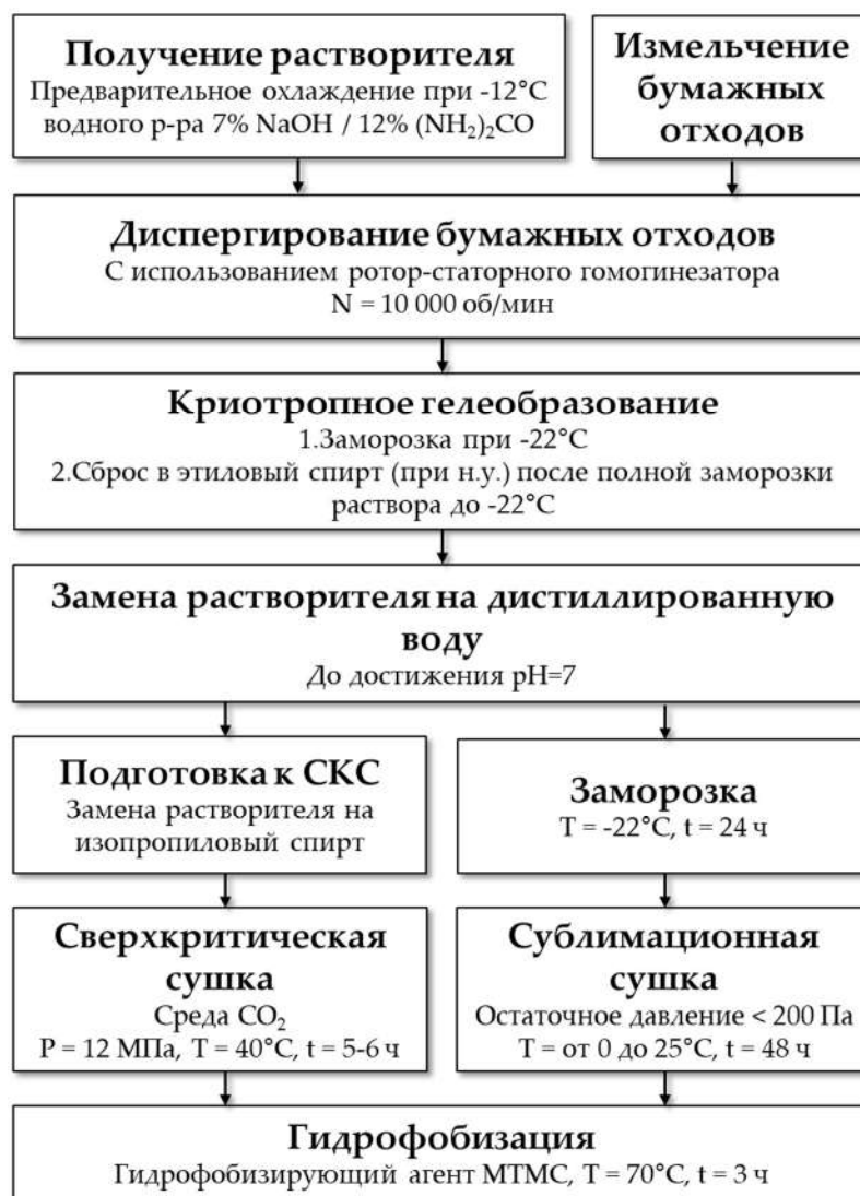
Рисунок 4.1 – Схема получения переработки бумажных отходов и получения высокопористого материала на основе целлюлозы
