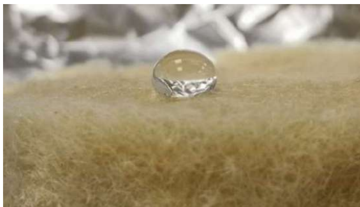
Рисунок 4.3 – Образец гидрофобного сорбента с каплей воды
