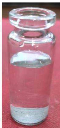
Рисунок 34 – Капсулированное карбонильное железо (А) и его взаимодействие с соляной кислотой (Б)
