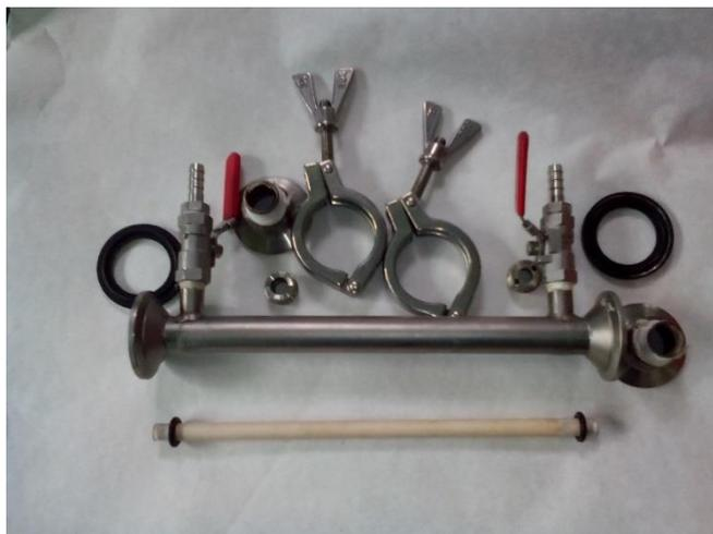
Рисунок 2.2 – Ультрафильтрационный модуль (в разобранном виде)
