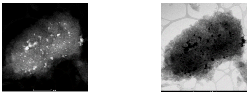
Рисунок 3.32 - Темнопольные и светлопольные ПРЭМ изображения образца 2%Fe-СПС-СВ
