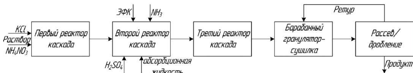
Рисунок 2.29 – Блок-схема получения NPK-удобрений с гранулированием и сушкой в БГС
