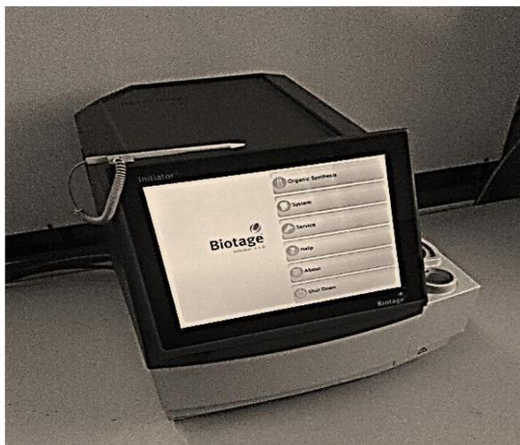
Рис. 14. Микроволновой реактор Biotage Initiator+
