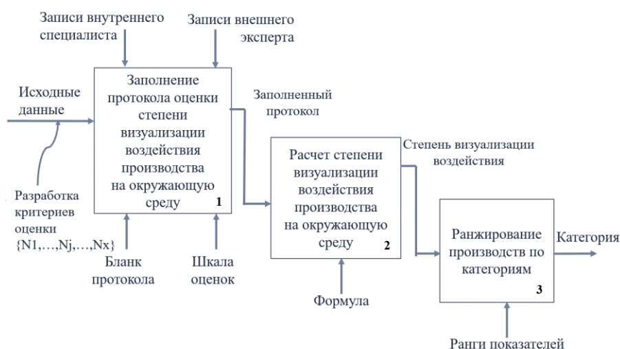
Рисунок 26 - Схема проведения оценки степени визуализации воздействия предприятий химической и нефтехимической отраслей промышленности на окружающую среду
