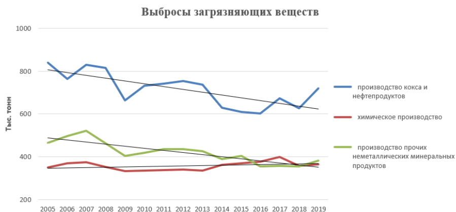
Рисунок 8 - Выбросы загрязняющих веществ в атмосферу стационарными источниками различных видов химических производств
