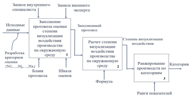
Рисунок 8 - Схема проведения оценки степени визуализации воздействия на окружающую среду предприятий химической и нефтехимической отраслей промышленности
