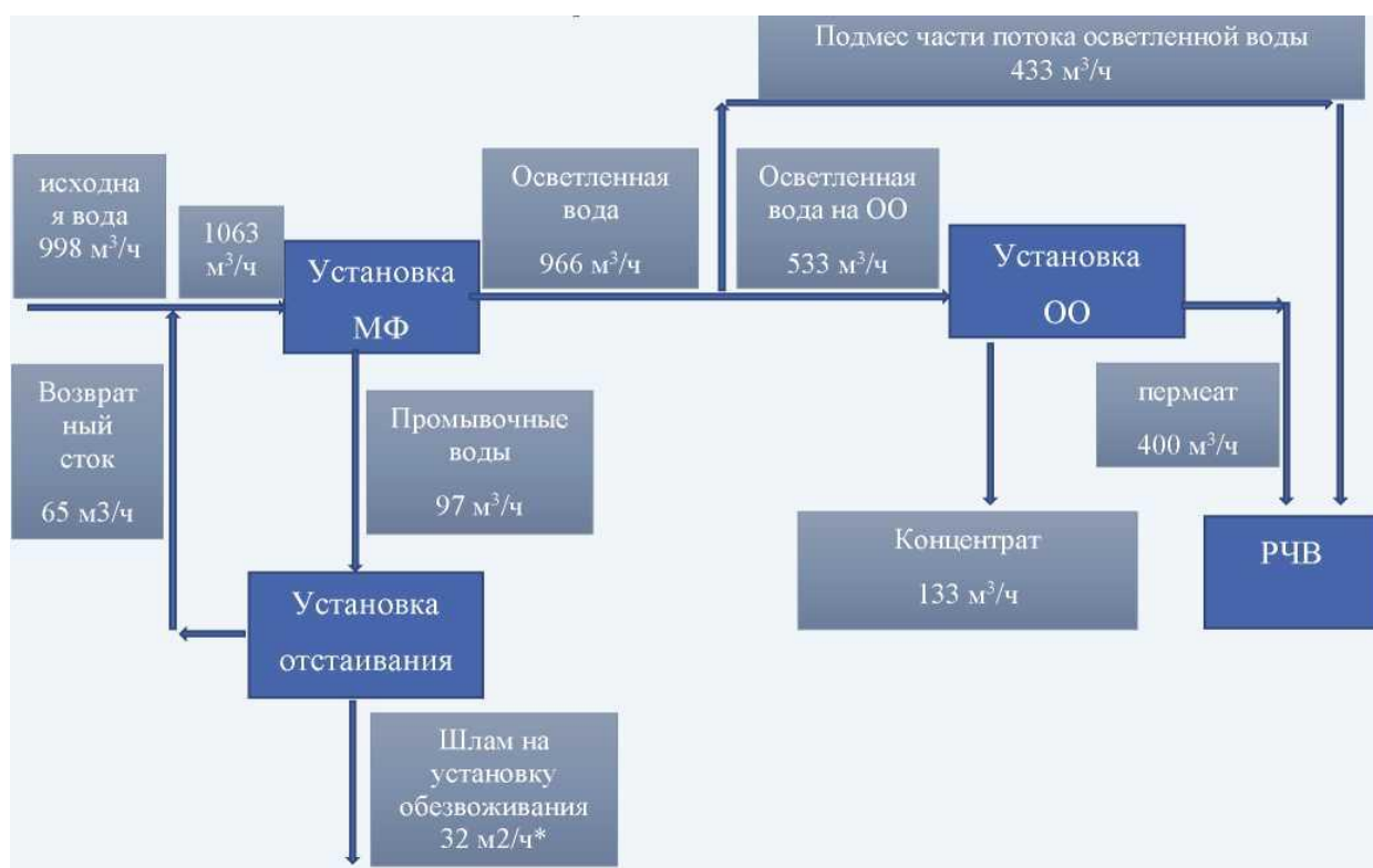
Рисунок 6.2– Предварительная балансовая схема с использованием обратного осмоса. Установка МФ (установка механической фильтрации); Установка ОО (установка обратного осмоса); РЧВ(резервуар чистой воды)
