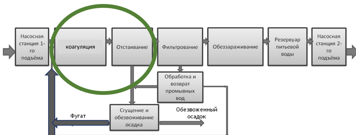
Рисунок 4.4 – Классическая технология обработки поверхностной воды. (Выделена область применения коагулянтов)
