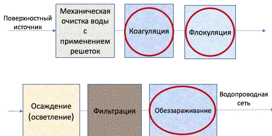
Рисунок 6.7 – Схема водоподготовки из поверхностного водного источника с указанием стадий, характеризующихся введением реагентов
