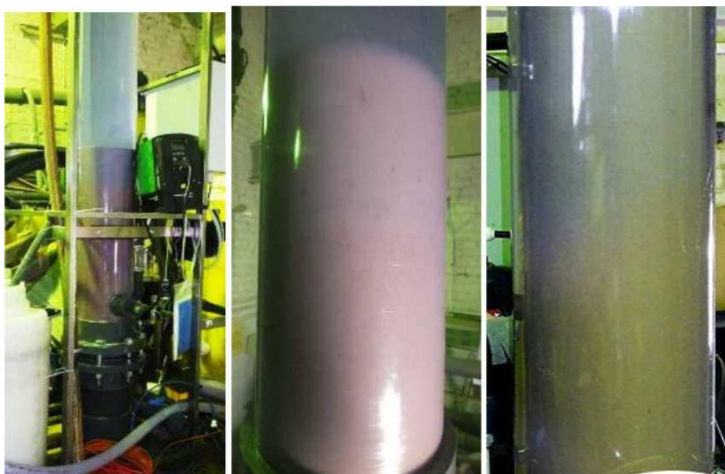
Рисунок – 6.6. Слой загруженного песка – а, слой в рабочем режиме – б, границы раздела – в
