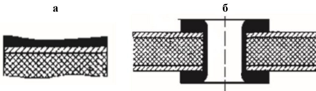
Рисунок 1.31 – Неравномерность гальванического покрытия: а – на поверхности; б – в отверстиях [17]
