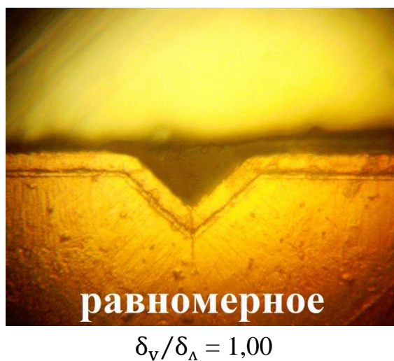
Рисунок 3.52 – Фотография (x500) поперечного шлифа регулярного микропрофиля с медным покрытием из базового электролита с I^1 , V^1 и Y^1
