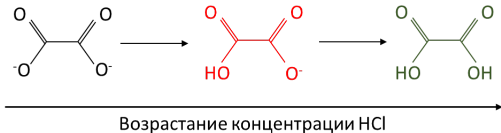
Рисунок 20 – Уменьшение концентрации диссоциированных форм щавелевой кислоты с повышением концентрации соляной кислоты
