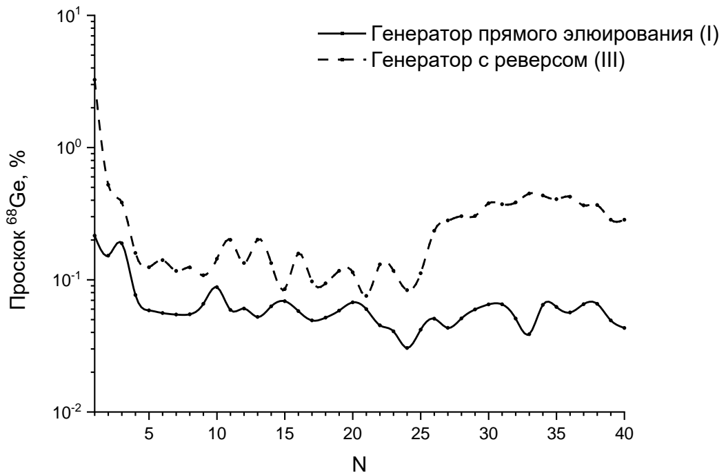
Рисунок 34 – Проскок ^{68}\text{Ge} для генератора с прямым элюированием (I) (сплошная) и генератора с реверсом (III) (штрих)
