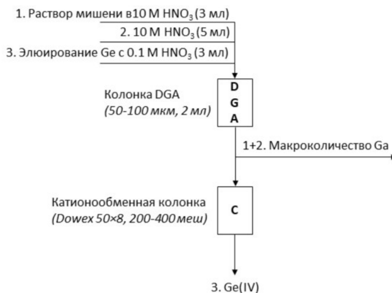
Рисунок 29 – Схема выделения радиоизотопов Ge(IV) из макроколичеств Ga(III)
