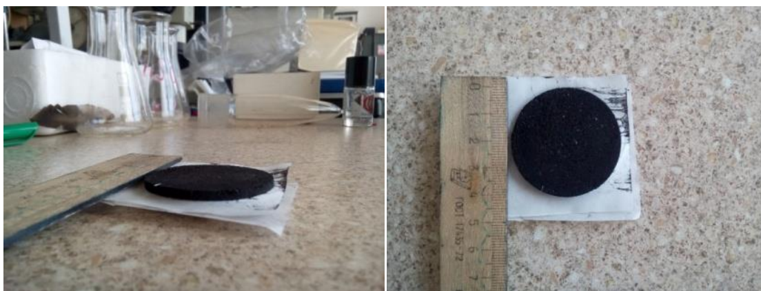
Рисунок 4.5 – Ионистор из брикетированного твердого углеродсодержащего остатка пиролиза автошин, облагороженного термической переработкой
