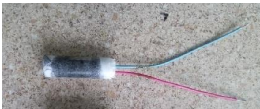
Рисунок 4.3 – Ионистор из твердого углеродсодержащего остатка пиролиза автошин, облагороженного термической переработкой
