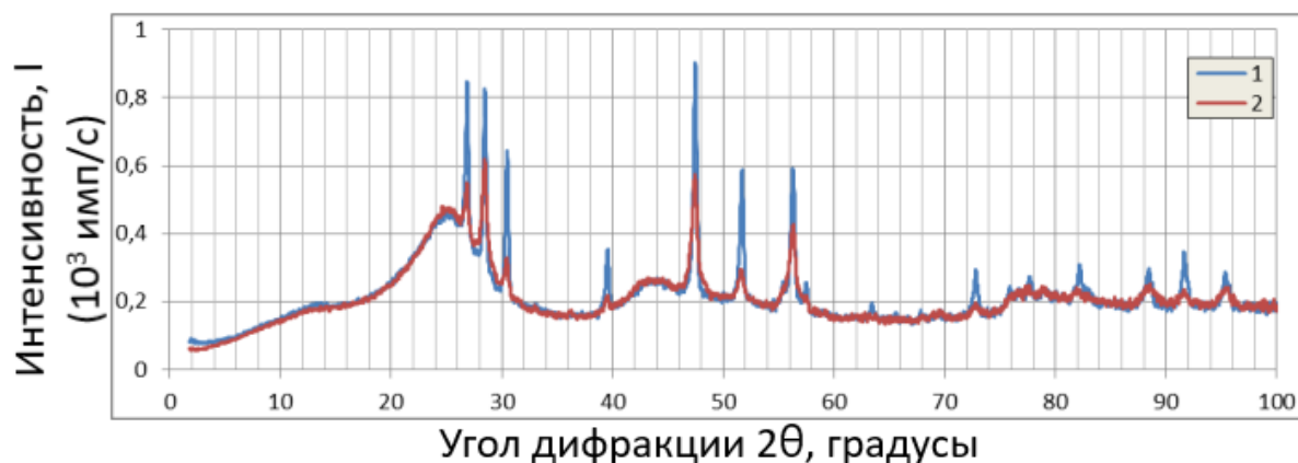
Рисунок 3.17 – Дифрактограммы образцов, умноженные на \sin\theta (для выравнивания интенсивностей): a – со сдвигом; б – без сдвига по вертикали и с коррекцией на поглощения (нормировка по рассеянию в области больших углов).
