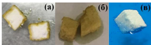
Рисунок 12 - Вытеснение воды трансмиссионным маслом в течение 5 (а) и 120 мин (б) из образцов с размером пор 4 мкм. Образец сорбента, плавающий на поверхности воды в течение 7 сут (в).
