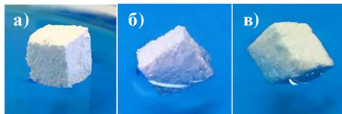
Рисунок 3.43 - Образец сорбента, плавающий на поверхности воды в течение 0 (а), 1 ч (б) и 7 сут (в)
