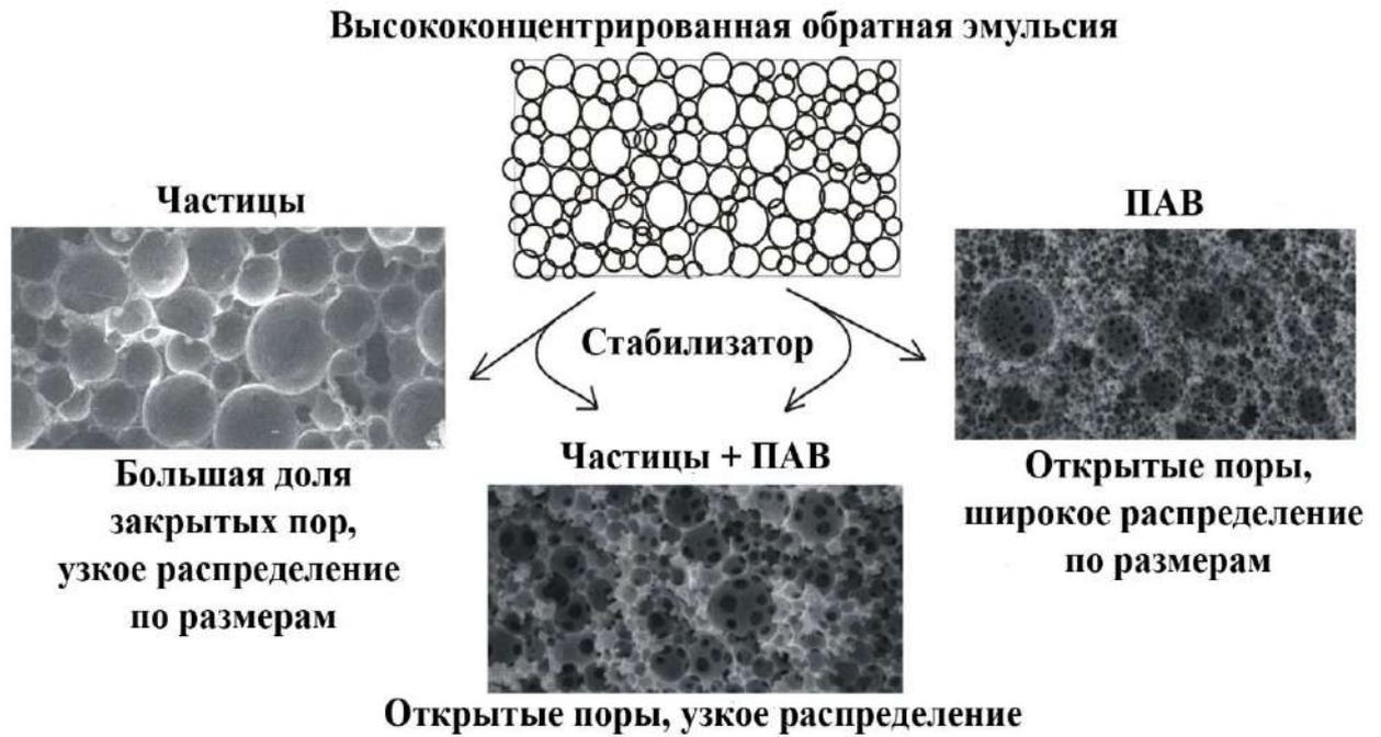
Рисунок 1.12 - Схематическое изображение влияния типа стабилизаторов ВКЭ на структуру пор материала, полученного полимеризацией её дисперсионной среды [100]
