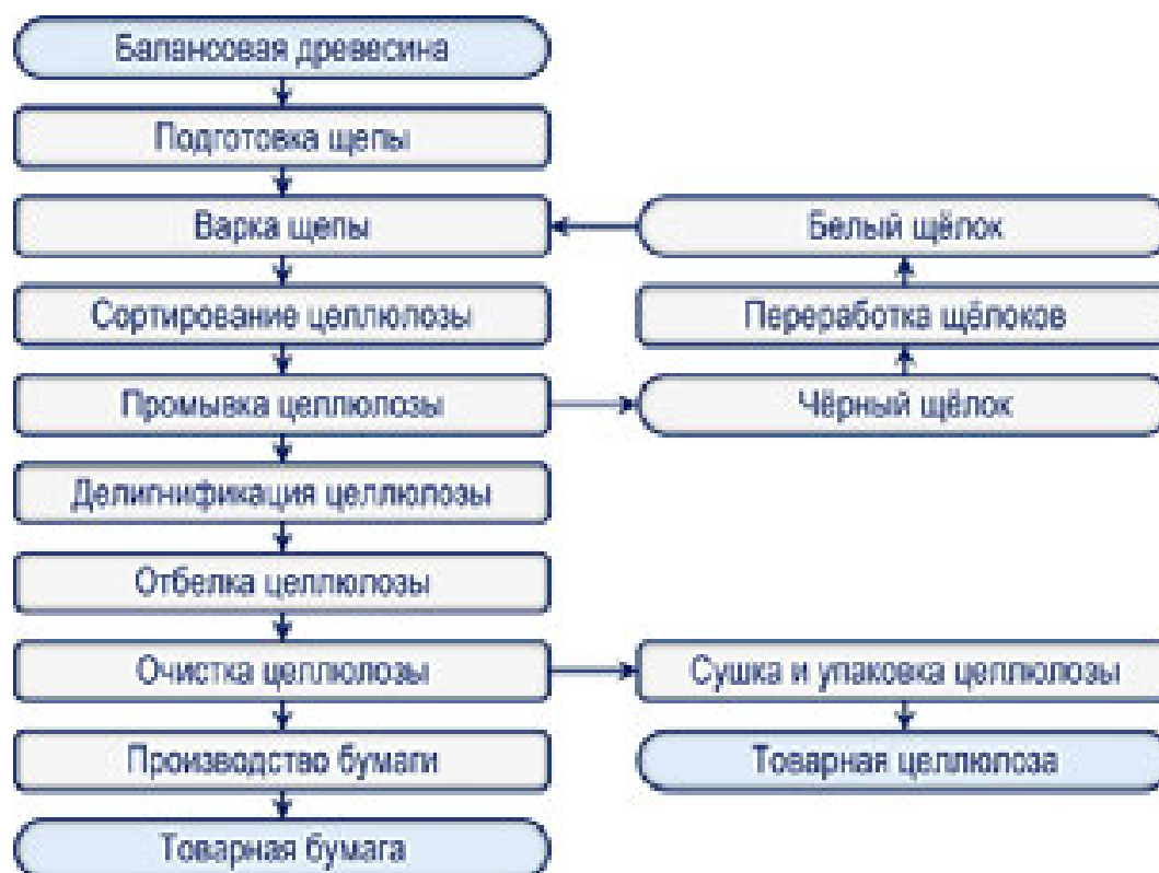
Рисунок 3.3 – Блок-схема производства целлюлозы и бумаги на интегрированном предприятии (составлен автором с использованием [188])
