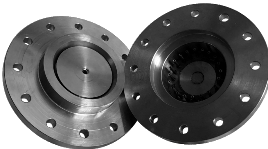
Рисунок 1 – Плоскокамерный радиальный мембранно-абсорбционный газоразделительный модуль
