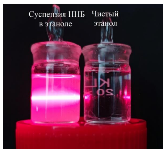
Рисунок 17 – Эффект Тиндаля, наблюдаемый в суспензии ННБ/этанол. Направление луча лазера справа налево
